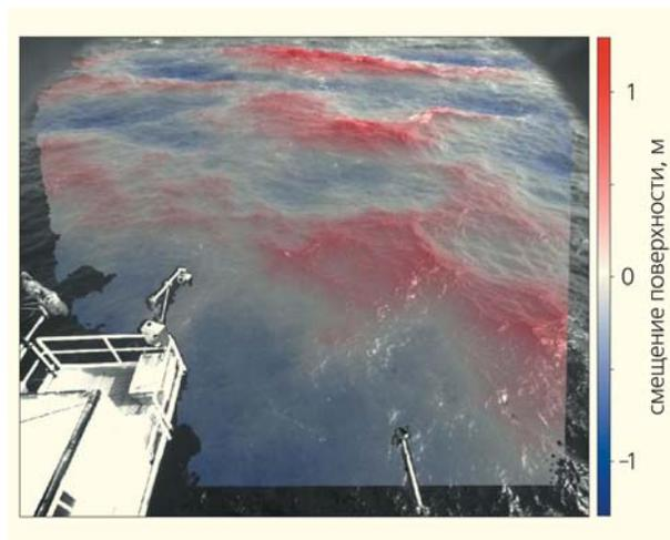
Рис. 17. Фотография морской поверхности с наложенной картой величин смещения поверхности (цветная шкала справа), определенных по данным стереометрии [25].
