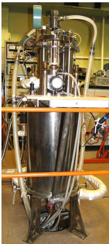
Рис. 1. Фото непрерывного субтерагерцового гиротрона с большой орбитой (ГБО).
