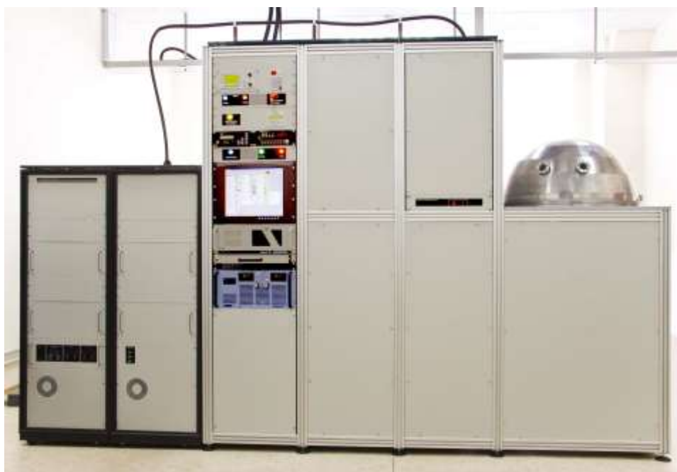
Рис. 1. Общий вид опытного образца промышленной установки для выращивания поликристаллического алмаза в плазме, создаваемой излучением гиротрона.
