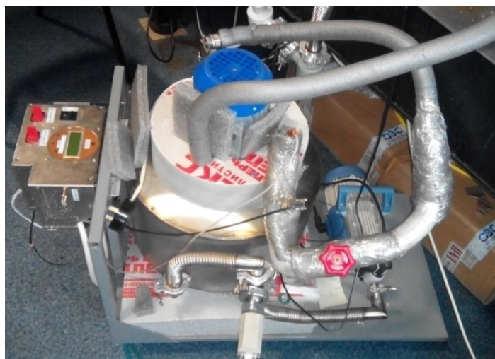
Рис. 64. Схема и внешний вид криогенной помпы для создания проточной системы охлаждения нового криогенного дискового квантрона.
