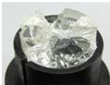
Рис. 13. Фотография композитного Yb:YAG/YAG элемента, расколовшегося под воздействием излучения накачки.
