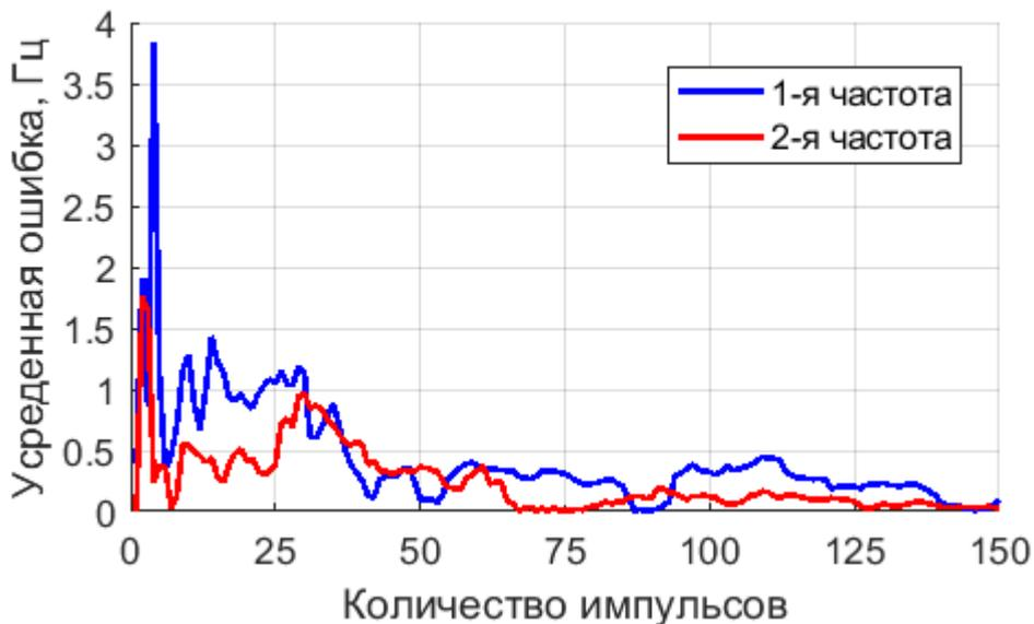
Рисунок 4.12 – Усредненная ошибка оценки частот относительно значений, определенных для неподвижной пластинки
