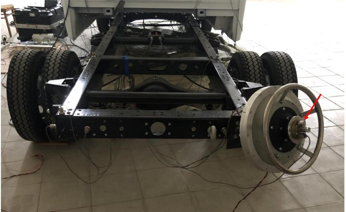
Рисунок 3.2 – Вибровозбудитель НТЦМ-2101 закрепленный за правый задний угол рамы, стрелкой отмечен опорный вибродатчик на корпусе вибратора
