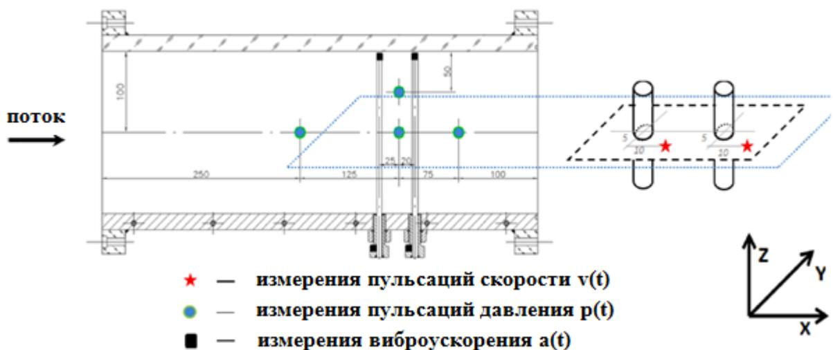
Рисунок 2.24 – Общая схема расположение областей проведения измерений из [84]
