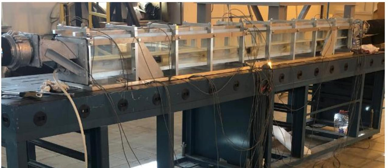
Рисунок 2.3 – Проточная часть проливного стенда с гидроакустической антенной (нижняя половина), установленной под звукопрозрачными капролоновыми пластинами
