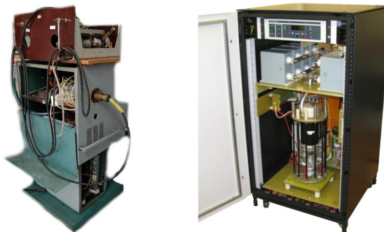
Рисунок 1.5 – Внешний вид высоковольтных источников питания пушек исполнения КП1, КП2 (слева), и ГИТ пушки исполнения КП3 (справа)
