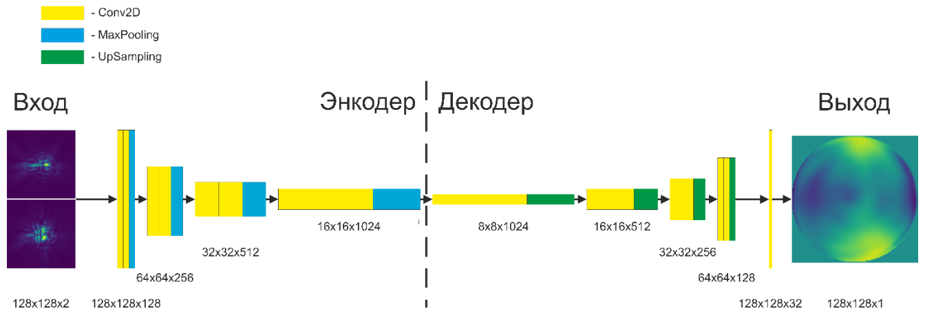
Рисунок 1.9. Схема нейронной сети. В качестве входных данных нейросеть принимает двухканальное изображение с распределением энергии в фокусе и в окрестности фокуса, а в качестве выходных данных выдает искажения волнового фронта.
