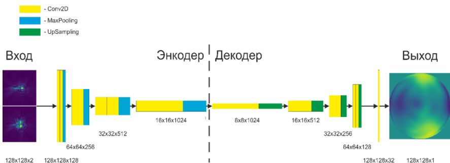
Рис. 1. Архитектура нейронной сети. В качестве входных данных нейросеть принимает двухканальное изображения флюенса в фокусе и при дефокусировке, а в качестве выходных данных выдает искажения волнового фронта
