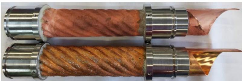
**Рис. 6.** Два образца синтезированного излучателя для 28 ГГц гиротрона, изготовленные путем трехмерной полимерной печати (верхний образец) и ЧПУ фрезерования (нижний)
